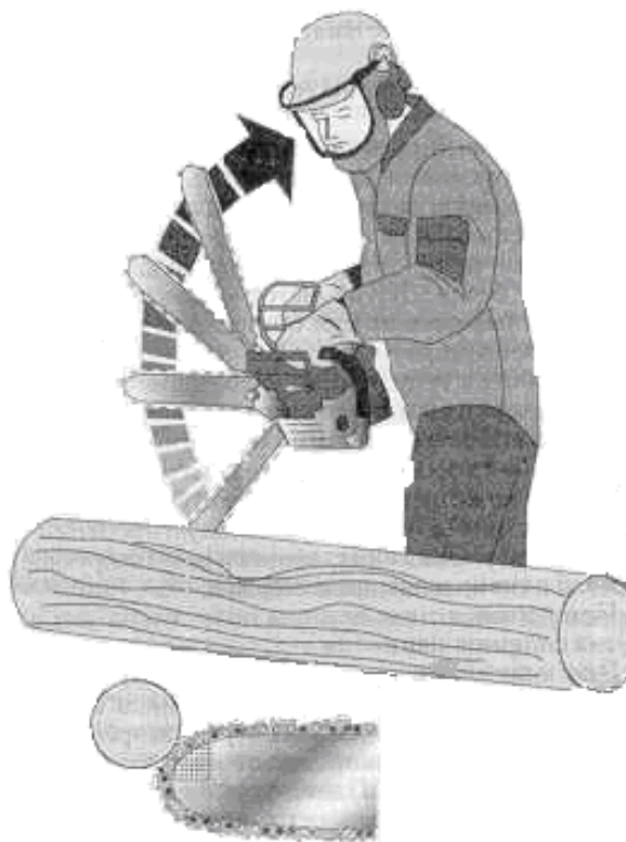
Рис. 5. Отдача цепной пилы
